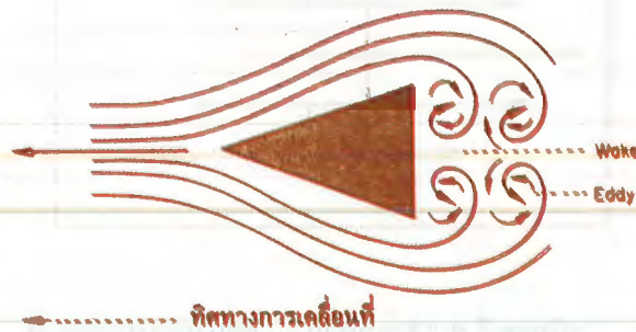
รูปภาพที่ 2.17 แสดงการเกิดระลอกน้ำและกระแสน้ำวน Eddies
