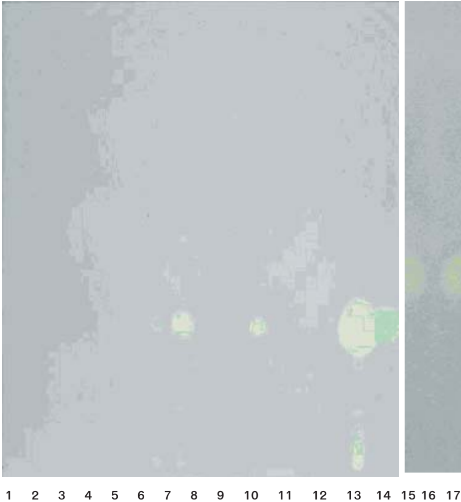
รูปที่ 3 ลักษณะทางโครมาโตแกรมผิวบางขององค์ประกอบทางเคมีที่มีฤทธิ์ต้านอนุมูลอิสระในน้ำมันหอมระเหย เมื่อใช้เฮกเซน/เอทิลอะซีเตท/กรดอะซีติก (90:10:1) เป็น mobile phase แล้วพ่นด้วยน้ำยา DPPH
